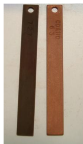
Fig. 1 – Coupons de corrosão de aço carbono e cobre do circuito.
